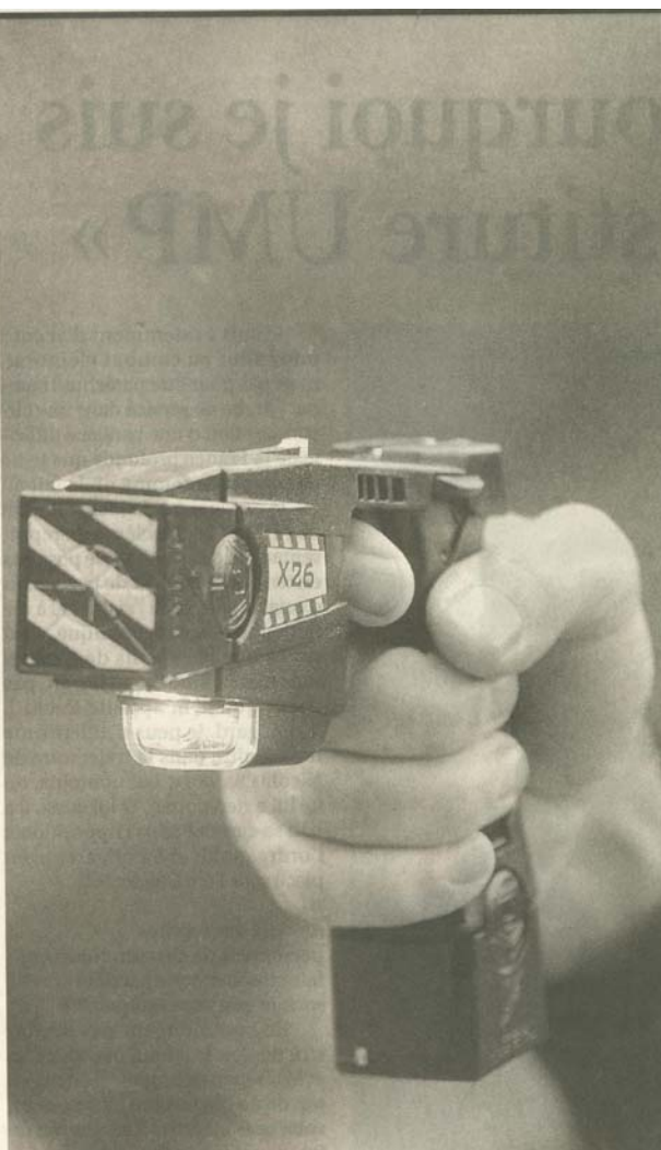
Le modèle choisi devrait être le Taser américain X 26, qui délivre des décharges électriques paralysantes par deux dards d'acier. Ludovic/Rea.
